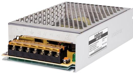
A fonte EFM 1210 é projetada para dispositivos 12 V com consumo de até 10 A. Ela possui proteção contra curto-circuito e sobrecarga, prevenindo danos decorrentes de avarias elétricas, e contra sobretensão, para evitar ou minimizar problemas causados por descargas atmosféricas ou manobras da rede de distribuição elétrica. Além disso, possui filtro contra ruídos e interferências na imagem.
